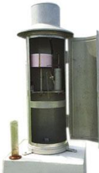
Gambar 3-2. Alat penakar hujan Otomatis Hillman
