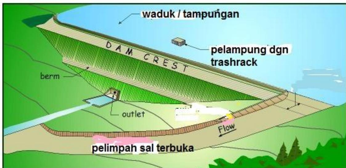
**Gambar 1.1-Illustrasi bangunan embung terdiri dari tubuh embung, pelimpah dan bangunan pengeluaran atau alat sadap**
