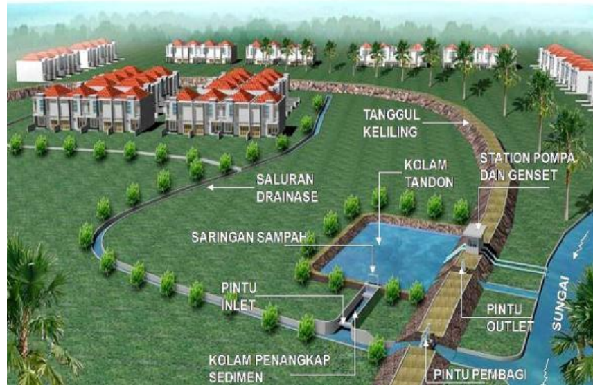
Gambar 6. Pintu air sistem polder dengan pompa dan kolam di samping saluran drainase
