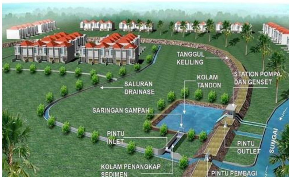
Gambar 25. Sistem polder dengan instalasi pompa terletak di dalam badan saluran/sungai
