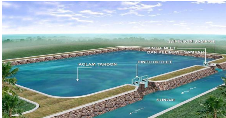
Gambar 4. Pintu air kolam retensi di samping badan sungai
