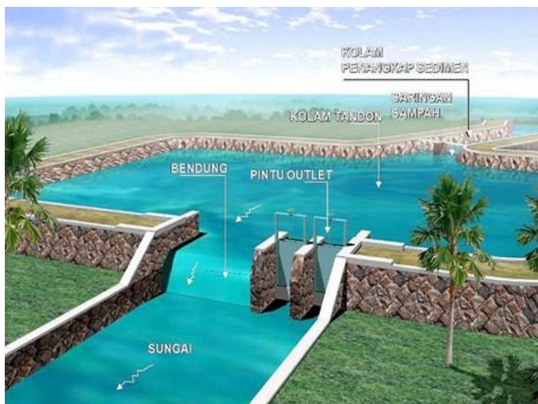
Gambar 24. kolam detensi dan retensi yang terletak di pada badan saluran/sungai
