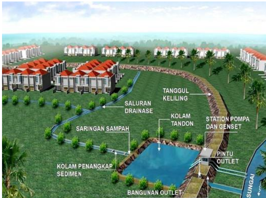
Gambar 27. Sistem polder dengan instalasi pompa terletak di samping badan saluran/sungai
