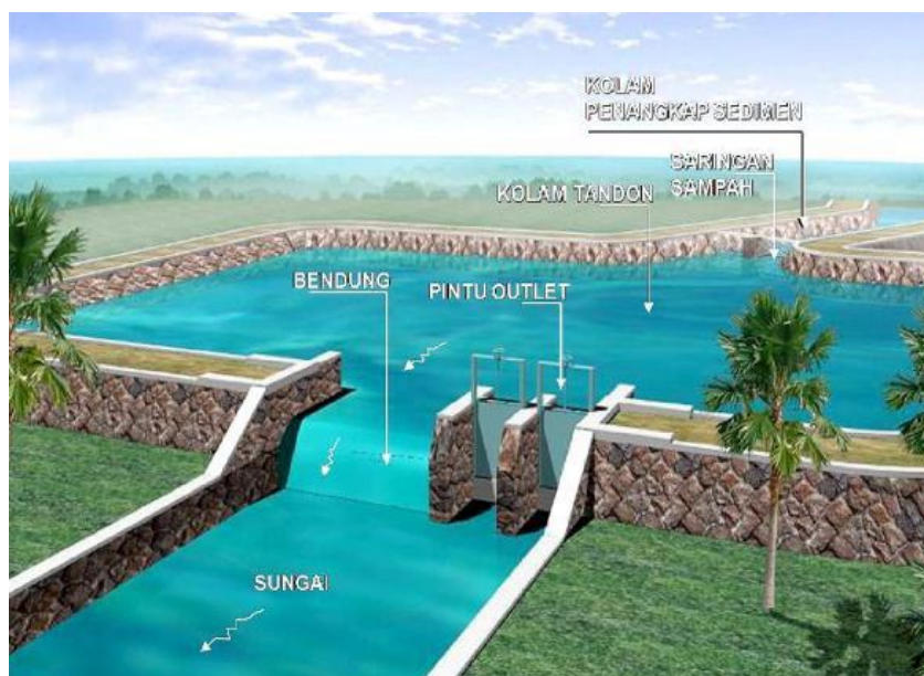
Gambar 5. Pintu air kolam retensi di dalam badan sungai
