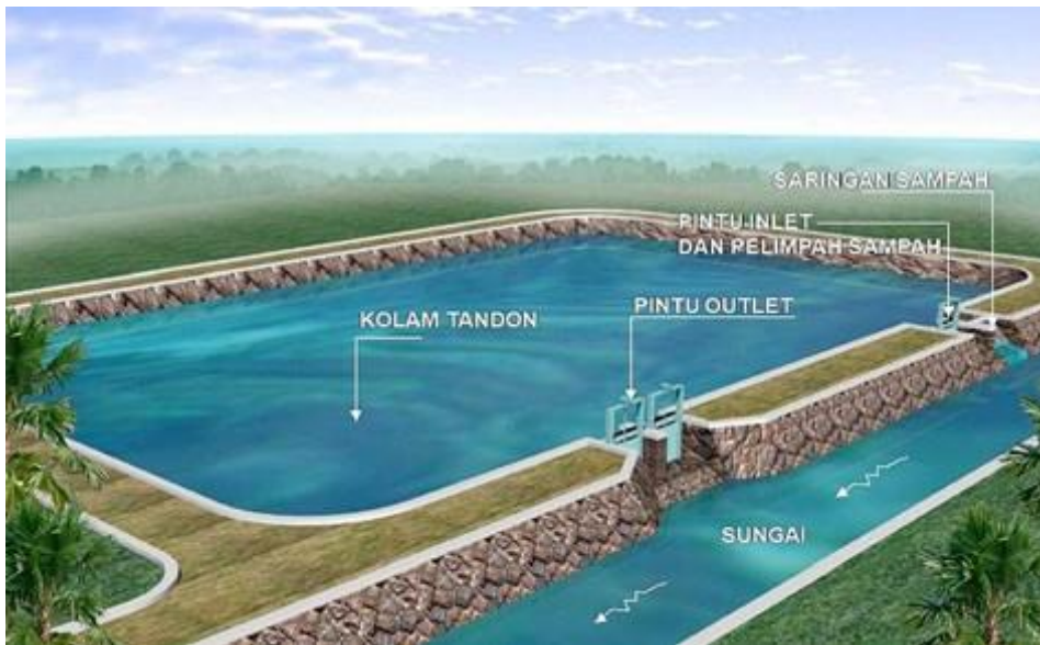
Gambar 22. kolam detensi dan retensi yang terletak di samping badan saluran/sungai
