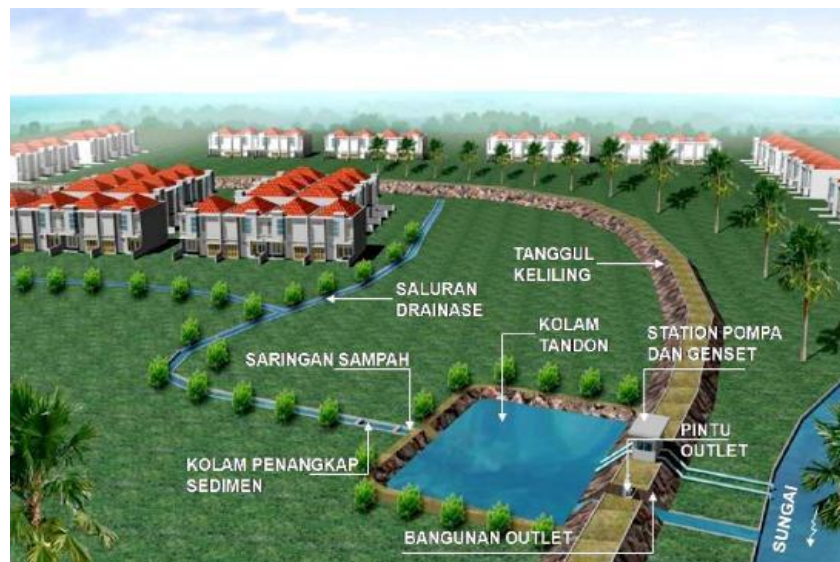
Gambar 7. Pintu air sistem polder dengan pompa dan kolam di badan saluran drainase
