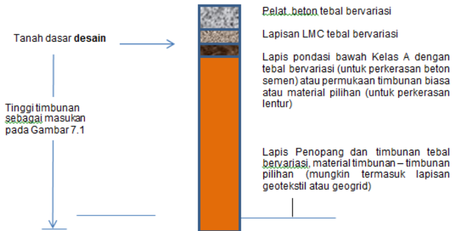
Gambar 4 - Struktur Perkerasan Kaku yang Digunakan dalam Analisa Gambar 3 (kasus perkerasan kaku)
