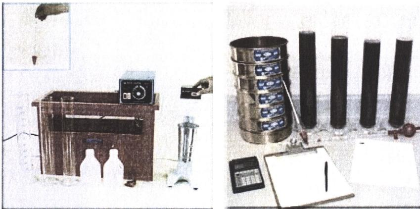
Gambar 5.7. Pengujian Hidrometer
