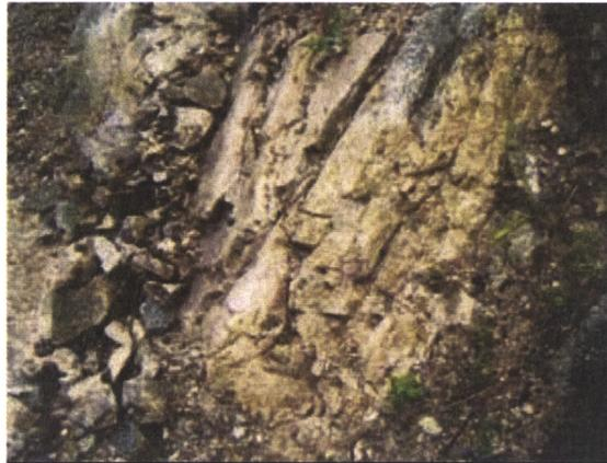
Gambar 4.6 Runtuhan pada Lereng Batu Pasir
